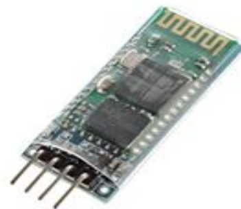
Fig-5: HC-05 Bluetooth module
